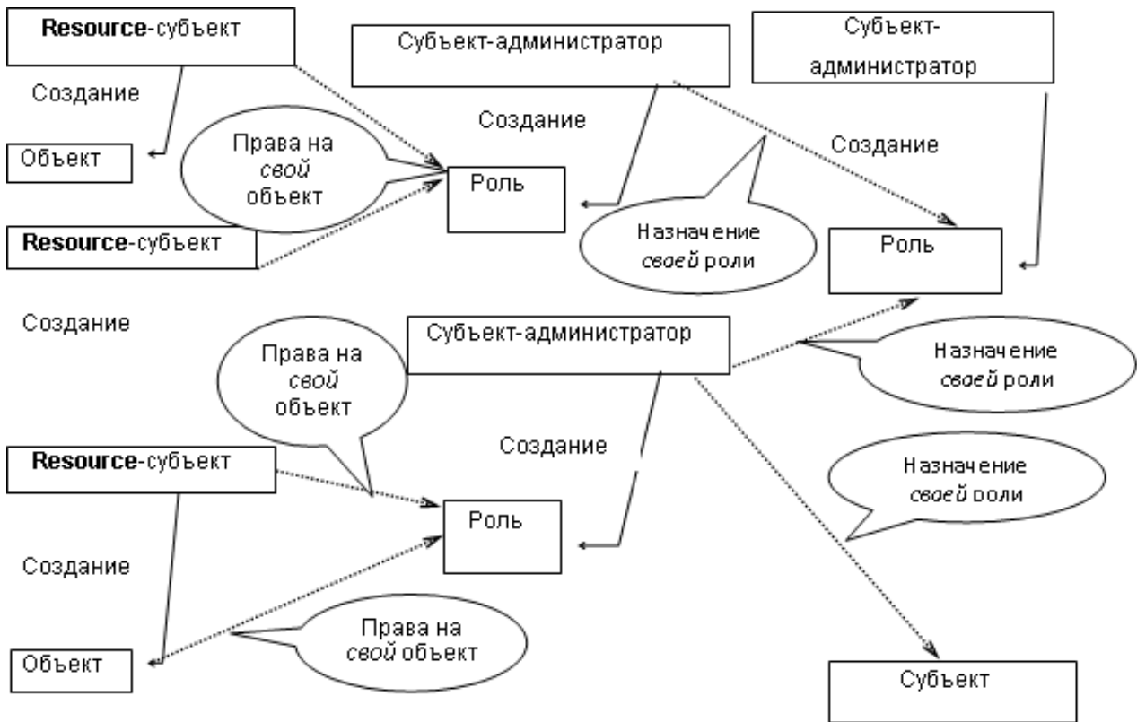
Рисунок 2. Схема построения ролей в СУБД ЛИНТЕР
